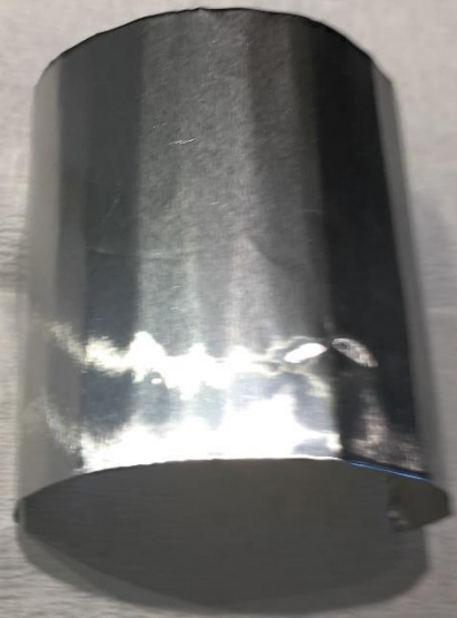
目視ではひび割れ・剥がれは確認されず
